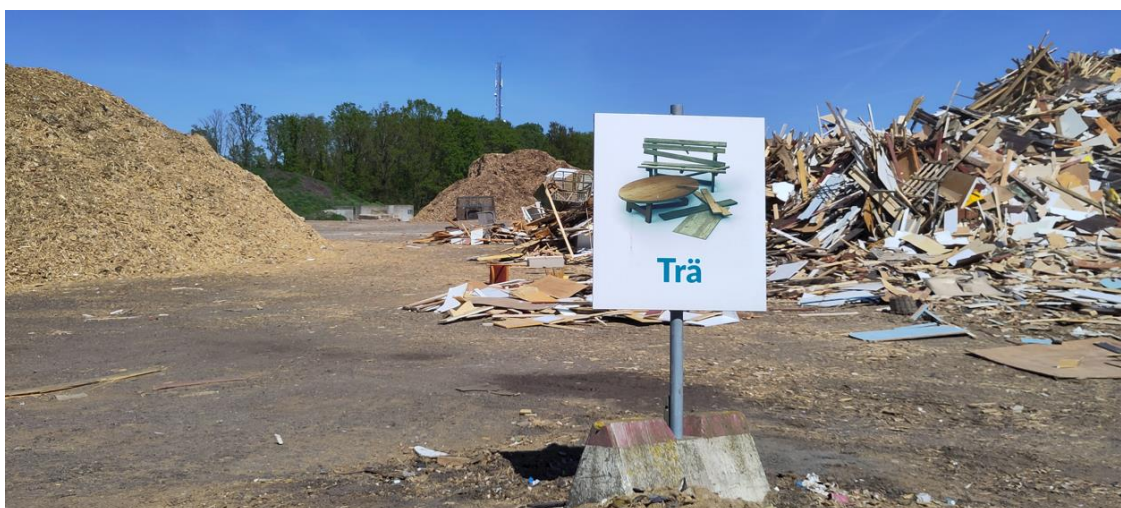
Figur 6-7. Separat insamlat träavfall flisas och avsätts i externa värmeverk
