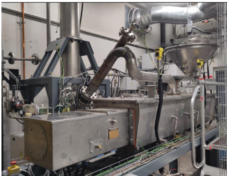
Figur 6-10. Pyrolysskruv för tester av produktion av biokol och bioolja från olika substrat, Biokolcentret RecoPark
