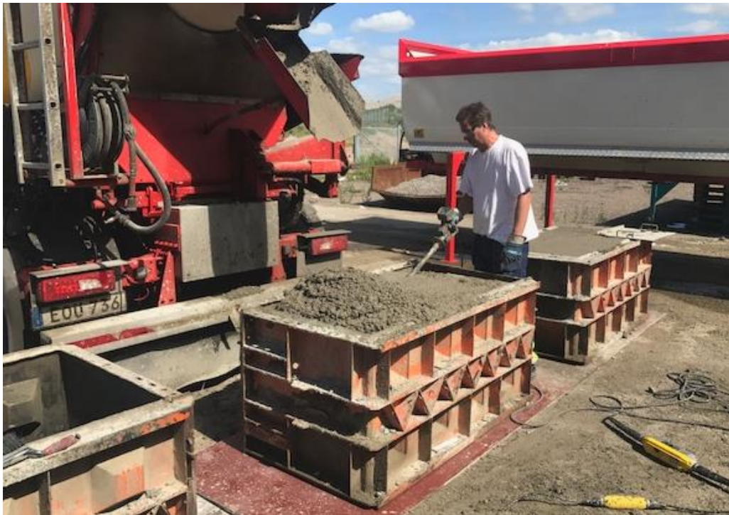
Figur 6-4. Tillverkning av betongblock med slaggrusinblandning
