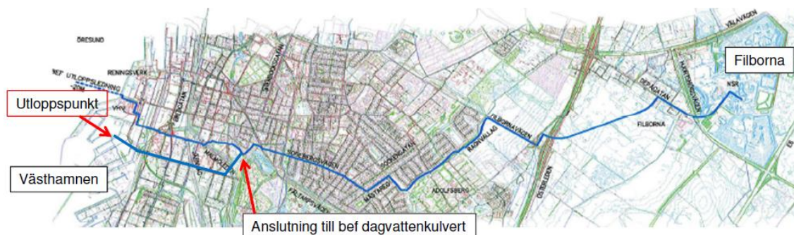
Figur 10-2. Ledningssträckning, utloppsledning från avfallsanläggningen till Västhavnen, Helsingborg.
