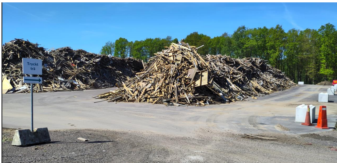
Figur 6-8. Tryckimpregnerat trä lagras på asfaltyta i avvaktan på kampanjvis krossning och uttransport
